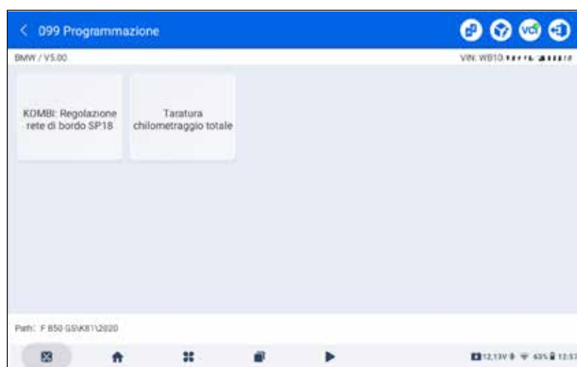
Figura 11: Funzioni di programmazione per rete di bordo e cruscotto su Ultradiag Moto
