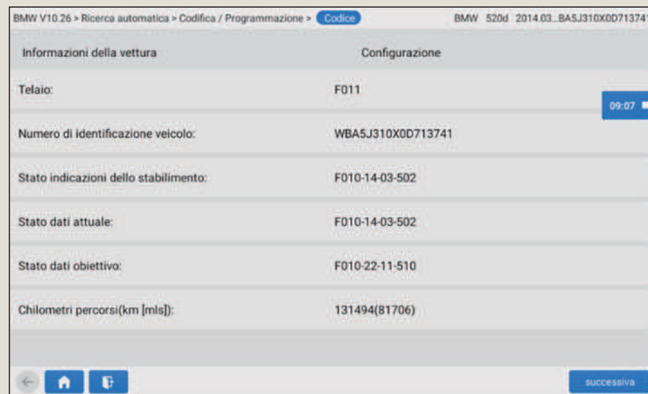
Figura 5: analisi della versione software del veicolo con possibilità di aggiornamento tramite Cloud Topdon
