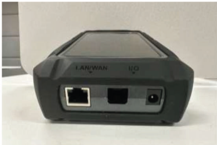
Porta Ethernet – porta dati I/O e porta di alimentazione
